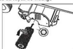
Contrôle de l'usure des brosses
