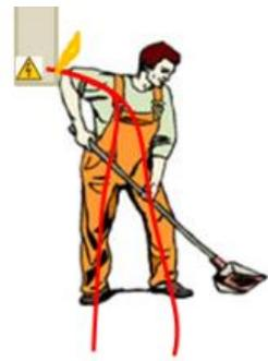
Les chocs électriques sans contact par amorçage en haute tension :
